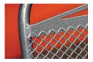
Malla en la que se amplía la abertura del diamante y se aplica un proceso de planchado, hasta obtener una forma cuadrada. Al igualar los lados del diamante, se obtiene un producto más ligero y con mayor paso de aire y temperatura.
